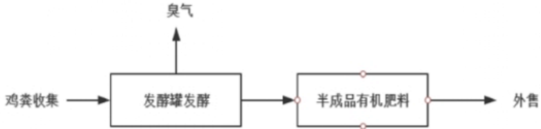
图 3.1.6-2 企业现有项目发酵工艺流程图
