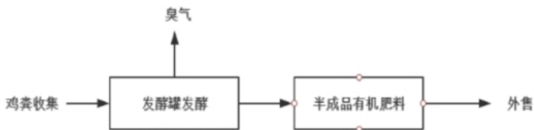
图 3.1.5-2 企业现有项目发酵工艺流程图
