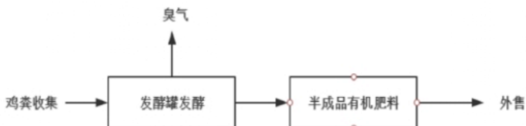
图 3.1.4-2 企业现有项目发酵工艺流程图
