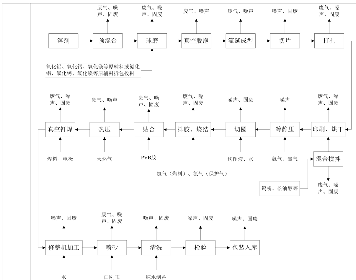
图 2-1 本项目氧化铝静电吸盘、氮化铝静电吸盘工艺流程图（航空产业园厂区）
