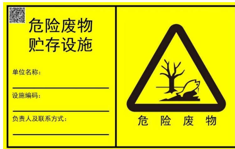
图 4-6 危废仓库室外危险废物标签
