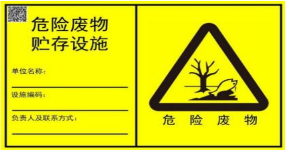
图 4-6 危废仓库室外危险废物标签
