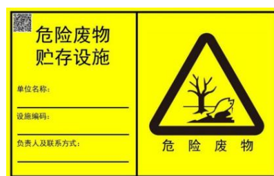
图 4-8 危废仓库室外危险废物标签
