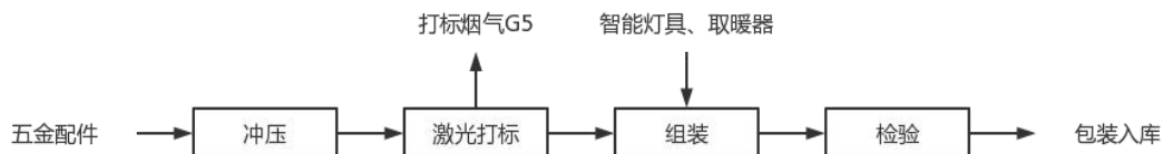
图 2-3 本项目智能灯具、取暖器生产工艺流程图
